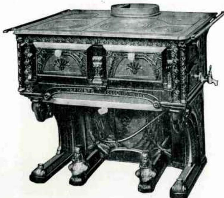
A consoles. — A retour de flammes. — Coup de feu à trois trous de cuisson. — Chaudière affleurante chauffée par le feu de l'âtre et par le foyer de la cuisinière. — Grand foyer mixte avec porte à rôtir sur façade. — Buse ovale sur le dessus : au milieu, et derrière. — Tirage direct à commande sur façade. — Mains courantes latérales. — Braisière.
